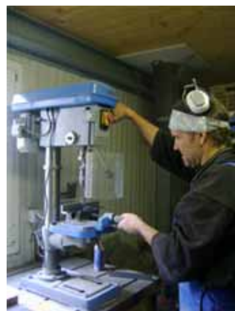
Ein Angestellter beim Bohren eines Loches für die Befestigung der Heitzür
